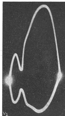
Abb. 2. dE/dt = f_1(E) -Kurve des Chinhydrons in \text{NH}_4\text{NO}_3 \cdot n\text{NH}_3 .
