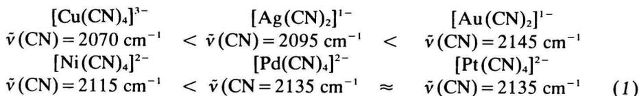
Bei gleicher Wertigkeit und Elektronegativität des zentralen Metallatoms sinken bei den Cyanokomplexverbindungen mit gemischten Liganden in Abhängigkeit vom Charakter des Liganden die Werte der Wellenzahlen der  $\tilde{\nu}(\text{CN})$ -Valenzschwingungen, im Fall des Einführens von Elektronendonator-Liganden, da die *d*-Orbitale des Metalls durch die  $\pi$ -Donazität des  $\text{PPh}_3$ - bzw.  $\text{PBU}_3$ -Moleküls beeinflusst werden (2).
