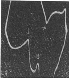
Abb. 3.  $dE/dt = f_1(E)$ -Kurve des  $\text{Hg}^+$  von der Konzentration  $2,5 \cdot 10^{-6}$  M nach 5 Minuten langer Elektrolyse, 1 M- $\text{HNO}_3$ .
