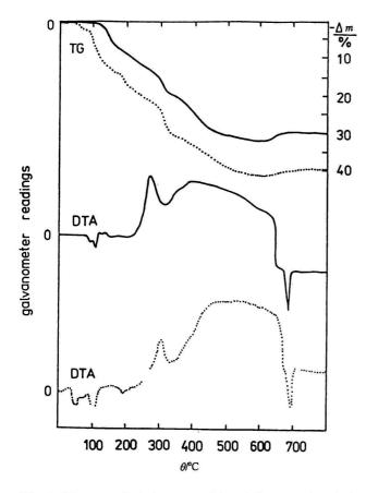
Fig. 2. Thermoanalytical curves of  $(DEAH)_4H_2V_{10}O_{28}$  (—) and  $(DEAH)_4H_2V_{10}O_{28}$  2H<sub>2</sub>O (...).
